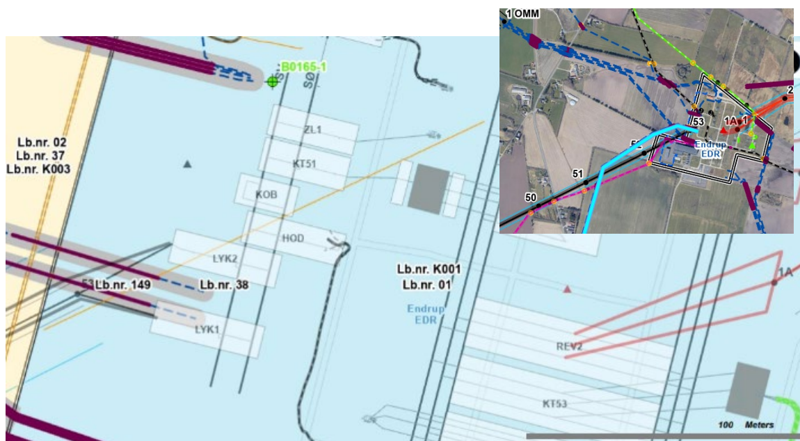
Figur 3.1 Kortet viser placering af LYK1 og LYK2 på Endrup Højspændingsstation. På oversigtskortet viser den blå streg, hvor de to nye 150 kV kabler tilsluttes på stationen.
